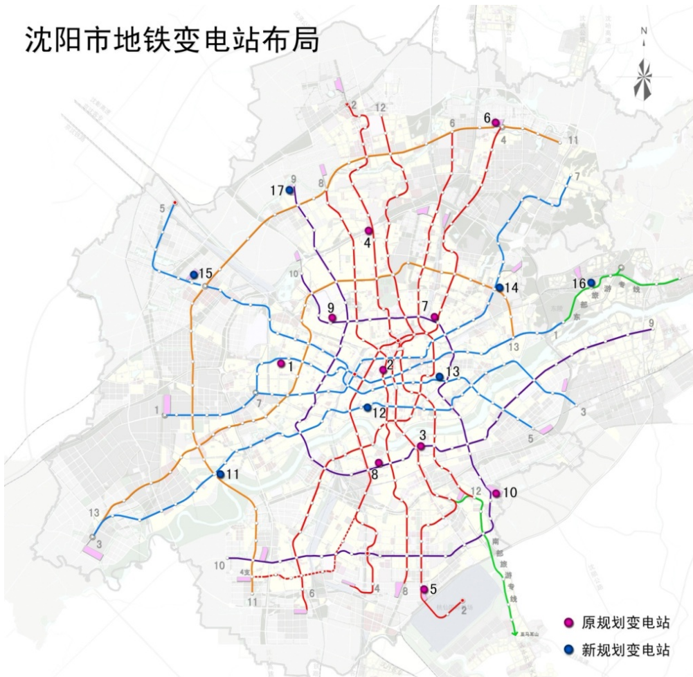
图3 沈阳市地铁变电站布局
