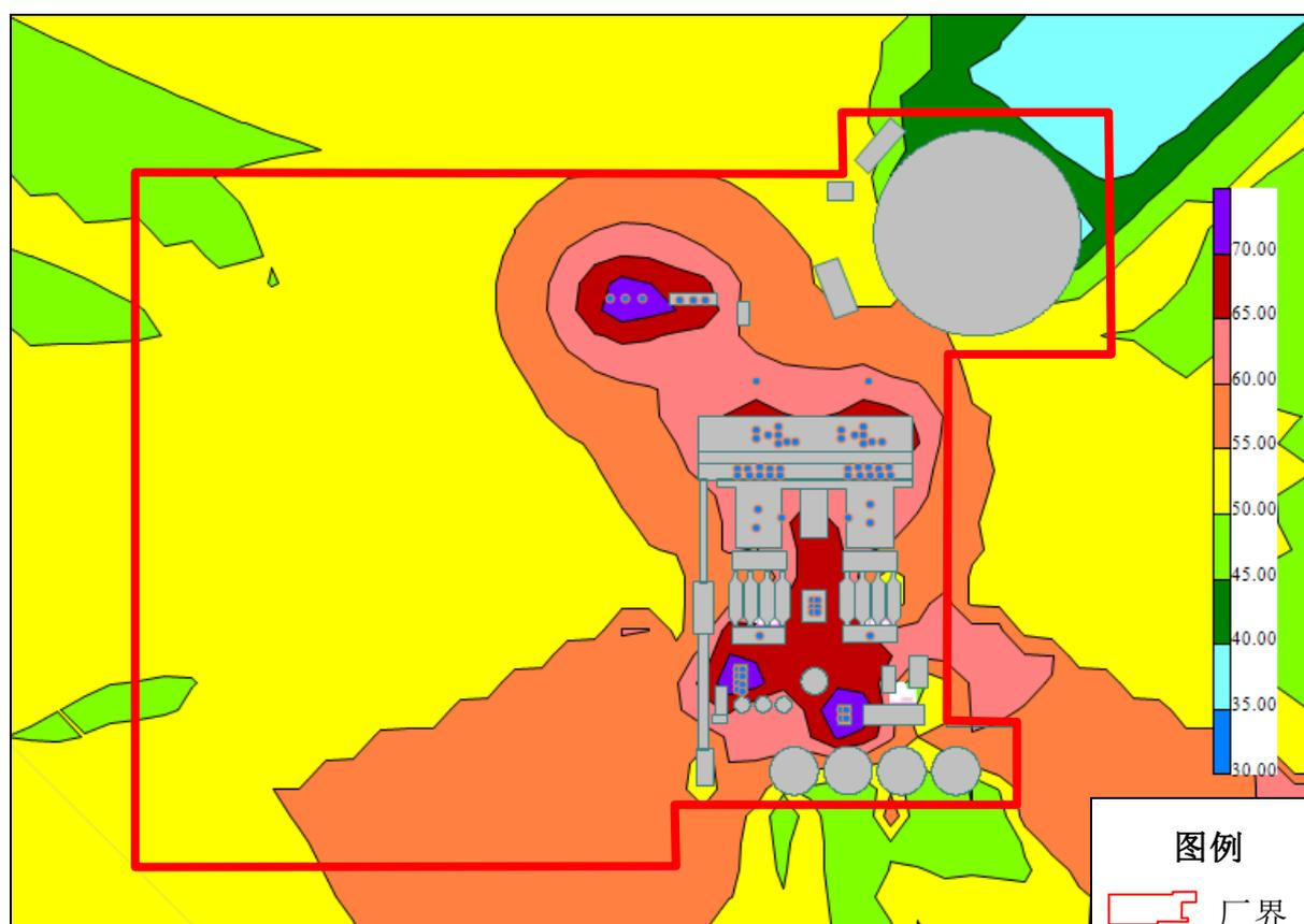
图5.4-2 锅炉排气工况厂界噪声等值线图
