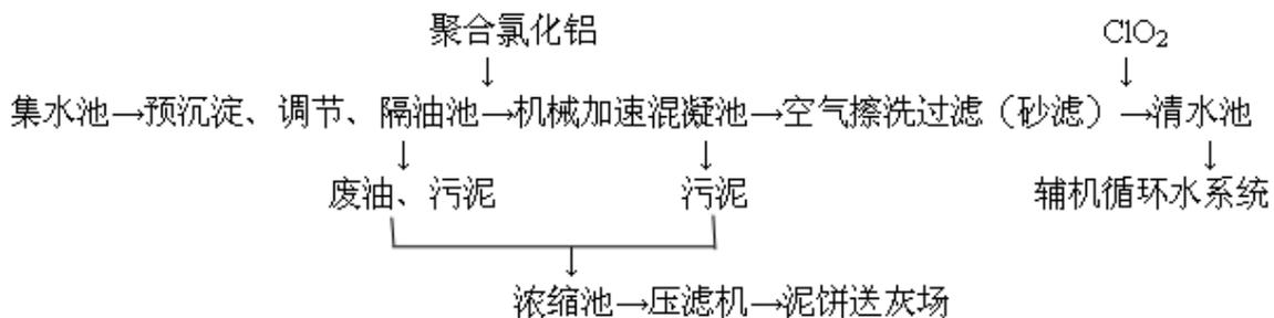
图3.3-10 工业废水处理站工艺流程图
