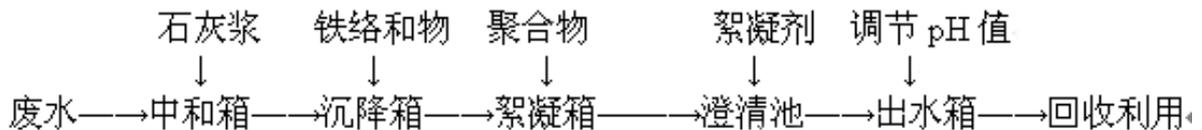
图3.3-11 脱硫废水处理工艺流程图
