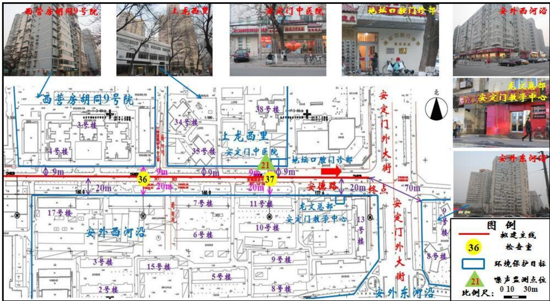
图 3.16 环境保护目标分布、现场照片及噪声监测点位图 (16)
