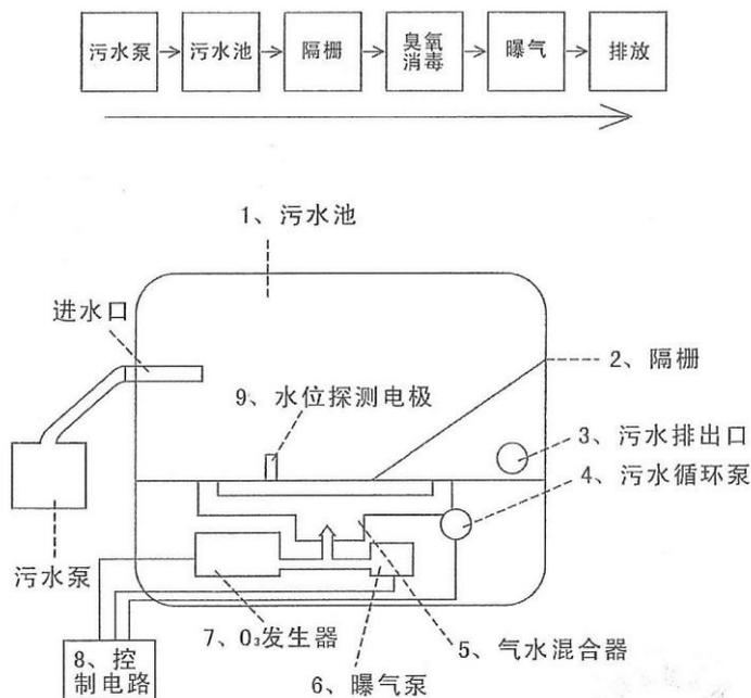
图4 污水处理设备工艺流程及结构图
