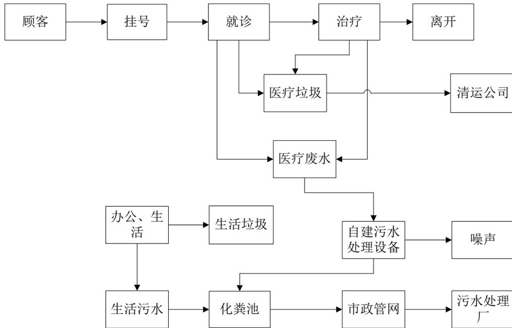
图2 项目生产工艺及产污节点
