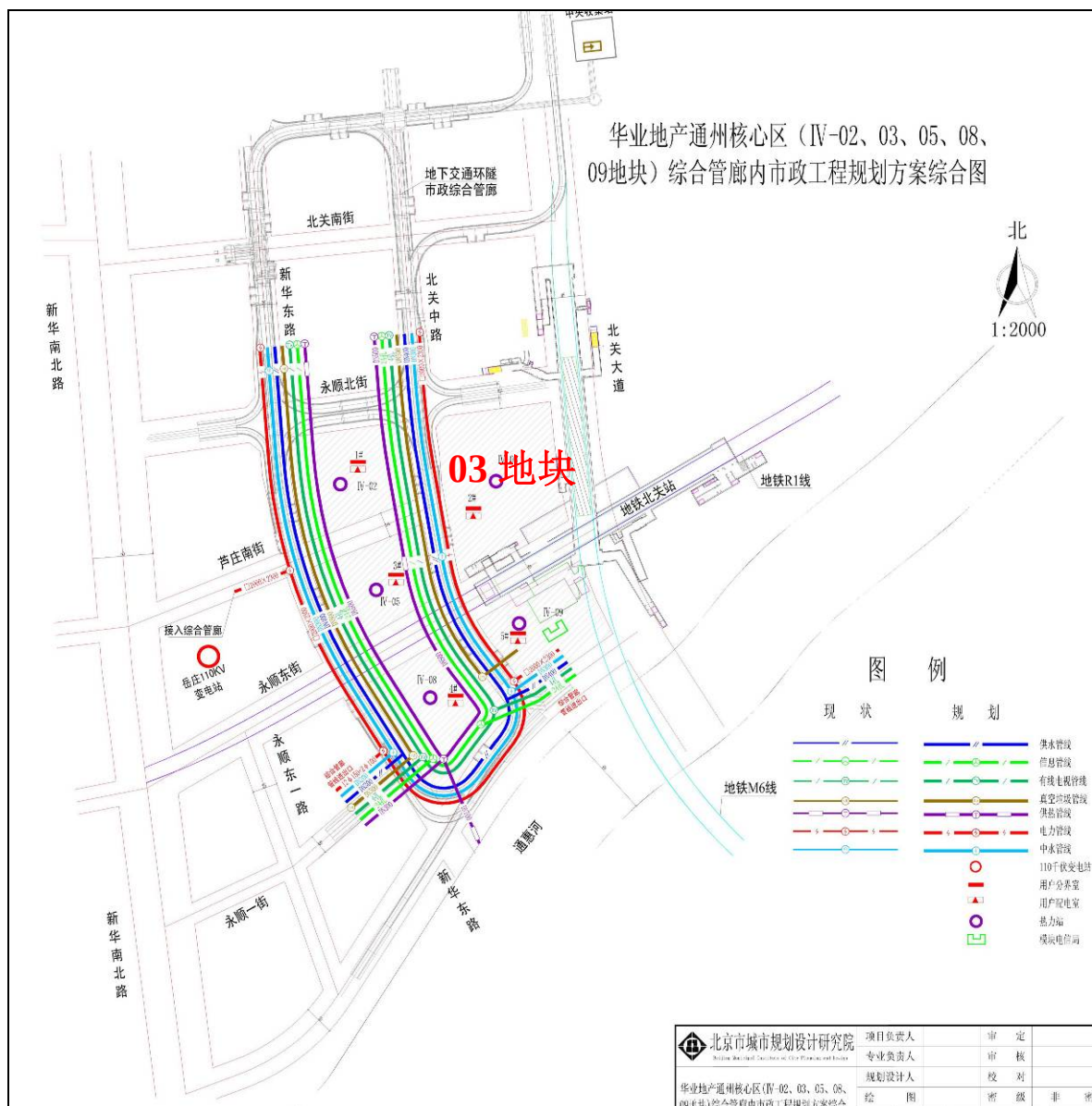
图 2.7-2 本项目周边市政管线图(综合管廊内)
